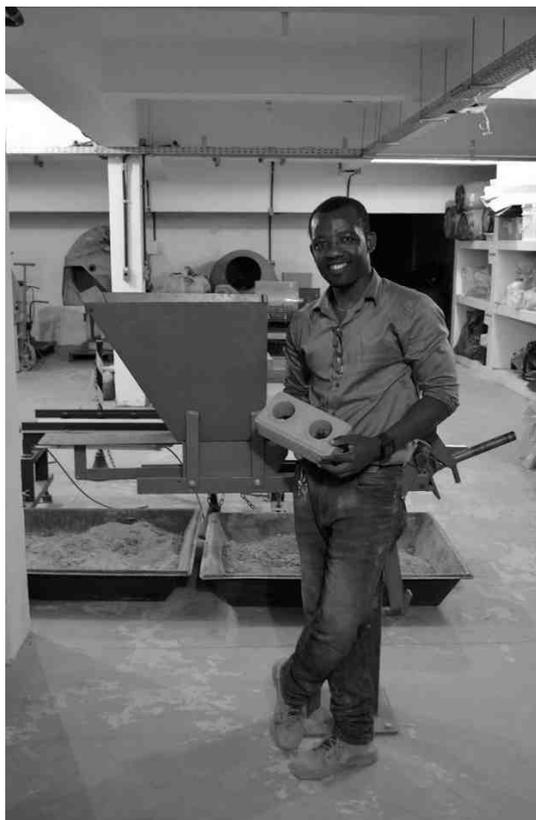
**JAC-SSONE ALERTE, “O cara do tijolo”. Ao fundo, prensa manual para fabricação de tijolos solo-cimento.**
